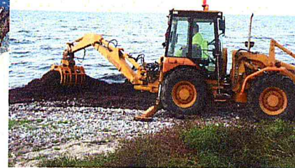
Zdj. Testowanie maszyn do zbierania glonów z plaży w Szwecji
